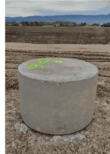
Messpunkt (Setzungspunkt) im Baufeld — Quelle: Mauthe GmbH
